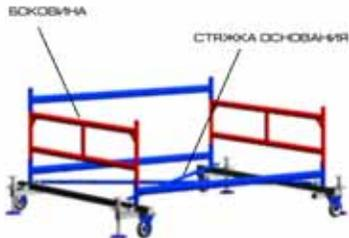
3. Установите боковины в установленные горизонталы. Горизонтальные элементы боковин служат ступеньками для подъема на рабочую площадку.
