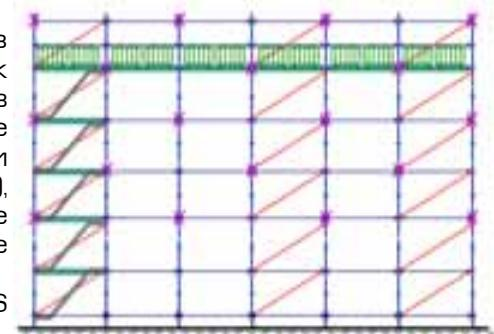
8. Закрепить конструкцию из строительных лесов к стене с помощью анкеров по следующей схеме (после высоты конструкции 6 метров (включительно), анкерные или любые другие соответствующие крепления, из расчета 1 крепление на каждые 6 кв.м. лесов) :
