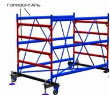
4. Установите в захваты нижних горизонталей скрещивающиеся стяжки и после установки верхних горизонталей вставьте верхние концы всех четырех стяжек с каждой стороны в соответствующие захваты
