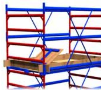
6. Рабочая платформа имеет ограждение, состоящее из двух боковин с расстоянием между перемычками 450 мм и двух поручней, связанных с нижними горизонтальными скрещивающимися стяжками.
