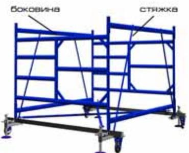
3. Установите боковины в установленные горизонталь и вставьте в боковые захваты рамы стяжки, по две с каждой стороны. Горизонтальные элементы боковин служат ступеньками для подъема на рабочую площадку.
