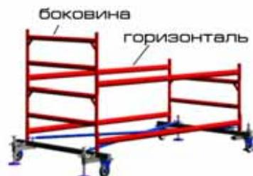
3. Установите боковины в установленные горизонталь. Горизонтальные элементы боковин служат ступеньками для подъема на рабочую площадку.
