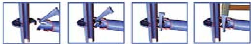
4. Вставить в отверстия стартовых элементов вертикальные стойки. Сварочный шов на фланце должен быть снизу.
