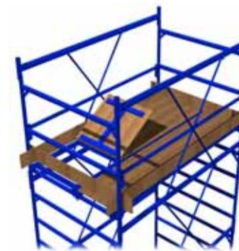
6. Рабочая платформа имеет ограждение, состоящее из двух боковин с расстоянием между перемычками 450 мм и двух поручней, связанных с нижними горизонтальными скрещивающимися стяжками.
