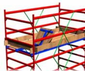
6. Рабочая платформа имеет ограждение, состоящее из двух боковин с расстоянием между перемычками 450 мм и двух поручней, связанных с нижними горизонтальными скрещивающимися стяжками.
