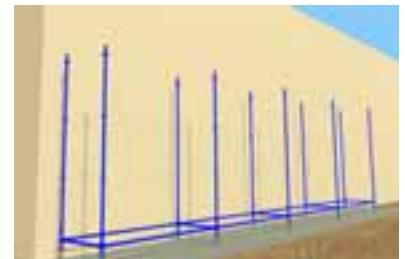
5. Связать вертикальные стойки горизонтальными элементами. Разместить в рабочей зоне настилы и лестницы.
