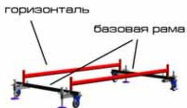
1. Установите параллельно две базовые рамы; вставьте между ними горизонталь
