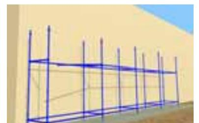
6. Для усиления жесткости конструкции закрепить диагональные элементы (см. Диагональный элемент).
