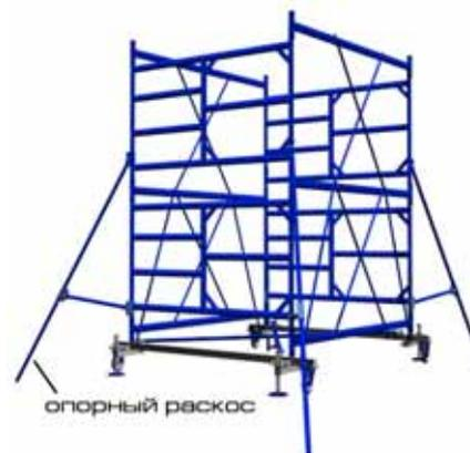
5. В такой последовательности (установка нижних горизонталей, установка боковин, установка верхних горизонталей и затем скрещивающихся стяжек) продолжайте монтаж помоста (туры). Если высота помоста превышает 4м, установите 4 дополнительные опоры.
