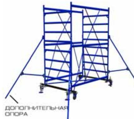
5. В такой последовательности (установка нижних горизонталей, установка боковин, установка верхних горизонталей и затем скрещивающихся стяжек) продолжайте монтаж помоста (туры). Если высота помоста превышает 4м, установите 4 дополнительные опоры.
